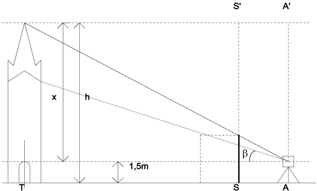
Eine Messstange der Höhe  $e$  wird bei  $S$  so aufgestellt, dass Stabende und Turmspitze beim Anvisieren vom Messinstrument bei  $A$  aus auf einer Geraden liegen. Mit Hilfe von Messungen bestimmt man folgende Längen:
